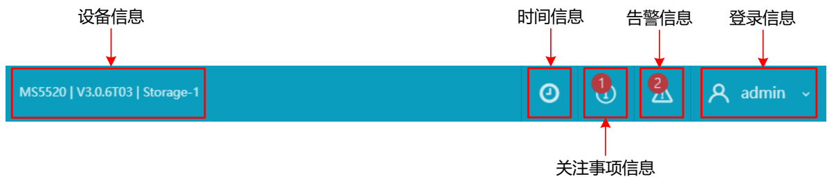
图3-6 ODSP Scope+导航栏示例
